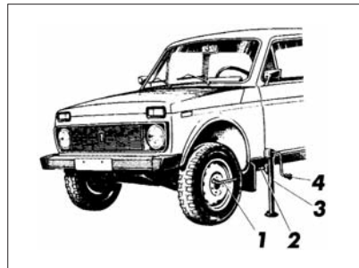
Рис. 44. Подъем автомобиля при замене колес
