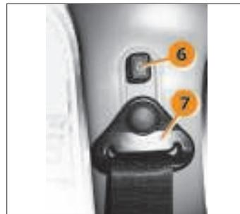
Рис. 2.10. Регулировка переднего ремня безопасности
