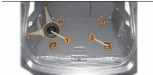
Рис. 9.8. Места крепления груза в багажном отделении
