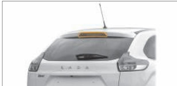
Рис. 8.23. Дополнительный сигнал торможения
