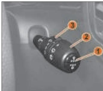
Рис. 1.27. Рычаг управления омывом и очисткой стекол
