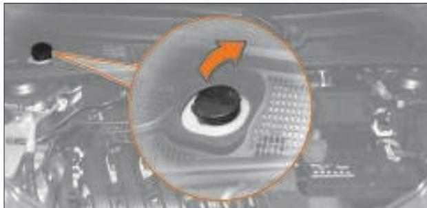
Рис. 8.8. Бачок стеклоомывателя
