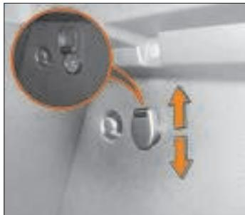
Рис. 7.5. Розетка для подключения дополнительного электрооборудования в багажном отделении
