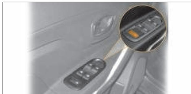
Рис. 1.18. Кнопка блокировки стеклоподъемников задних дверей (в варианном исполнении)
