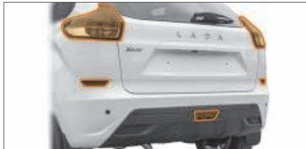
Рис. 9.12. Рассеиватели световых приборов задние
