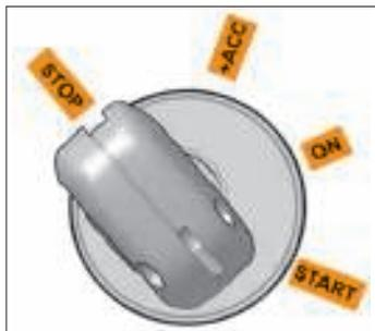
Рис. 1.7. Выключатель зажигания
