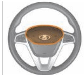
Рис. 3.10. Активация звукового сигнала
