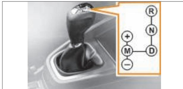
Рис. 4.2. Селектор автоматизированной трансмиссии
