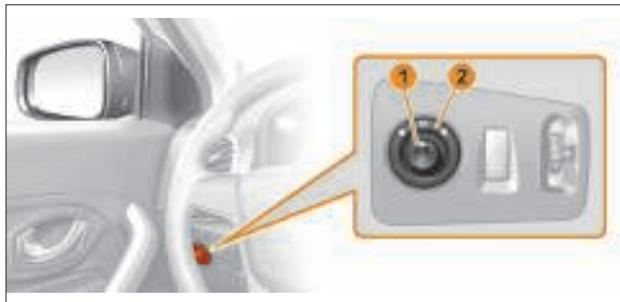
Рис. 3.13. Регулировка зеркал заднего вида с электроприводом (в **вариантном исполнении**).
