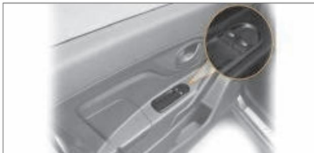
Рис. 1.16. Блок переключателей на двери водителя
