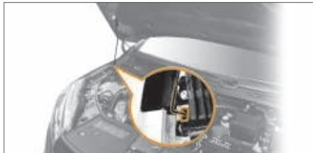
Рис. 8.3. Упор капота
