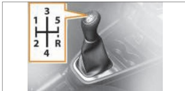
Рис. 4.1. Рычаг переключения механической коробки передач
