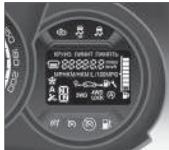
Рис. 3.7. Дисплей бортового компьютера
