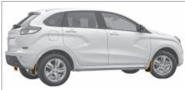
Рис. 9.10. Щитки переднего и заднего крыла
