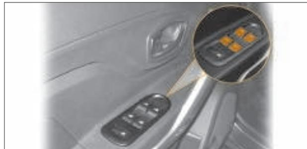
Рис. 1.17. Блок переключателей на двери водителя (в варианном исполнении)
