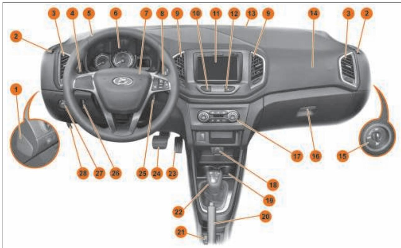
Рис. 3.1. Органы управления и приборы (в варианном исполнении)
