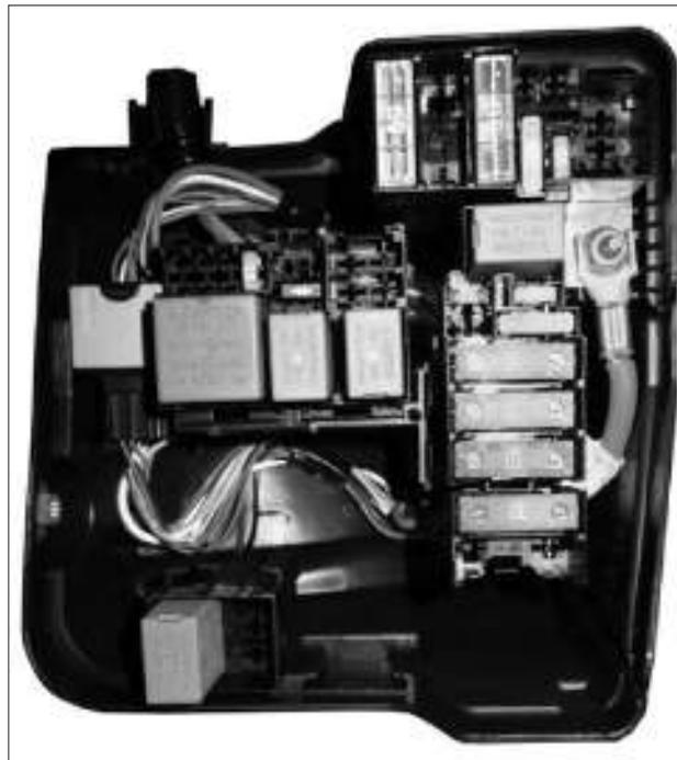
Рис. 8.28. Монтажный блок моторного отсека
