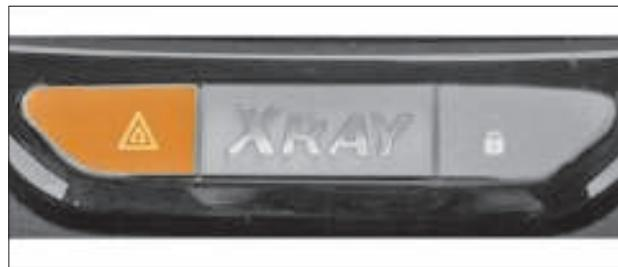
Рис. 1.11. Кнопка аварийной световой сигнализации
