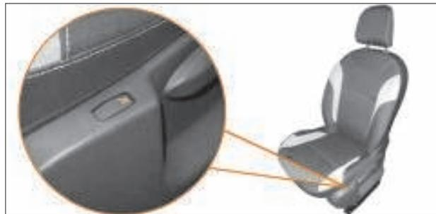
Рис. 2.4. Выключатель подогрева передних сидений (с фиксированными положениями)
