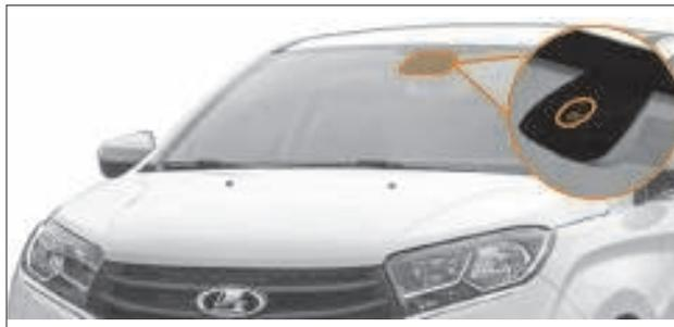
Рис. 1.26. Датчик дождя и света
