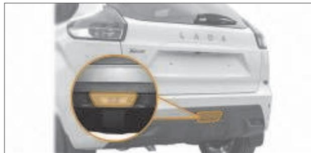
Рис. 8.14. Задний противотуманный фонарь
