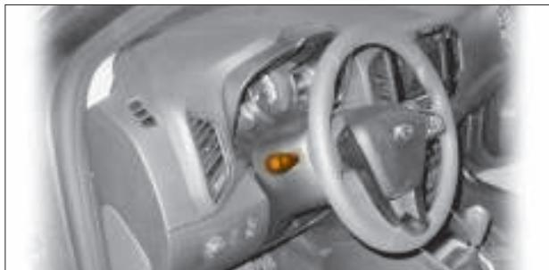
Рис. 1.22. Переключатель световой сигнализации
