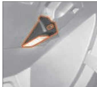
Рис. 7.6. Плафон освещения вещевого ящика
