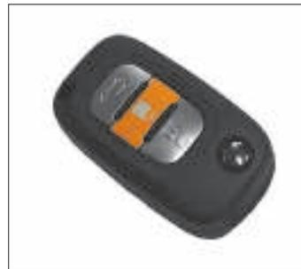
Рис. 1.4 Кнопка «БЛОКИРОВКА» пульта дистанционного управления
