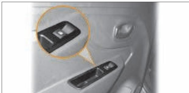
Рис. 1.20. Кнопка управления электрического стеклоподъемника задней двери (в варианном исполнении)
