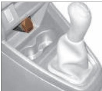
Рис. 7.3. Розетка для подключения дополнительного электрооборудования
