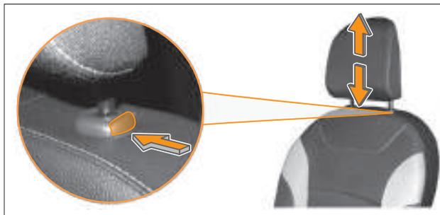
Рис. 2.6. Регулировка высоты
