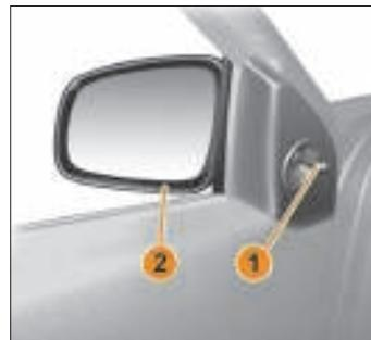
Рис. 3.12. Наружные зеркала заднего вида с ручной регулировкой
