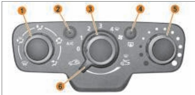
Рис. 6.2. Панель управления климатической системой с ручным управлением и кондиционером (**в вариантом исполнении**)
