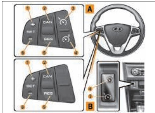
Рис. 5.1. Блок управления системами «Круиз-контроль» и «Ограничитель скорости»
