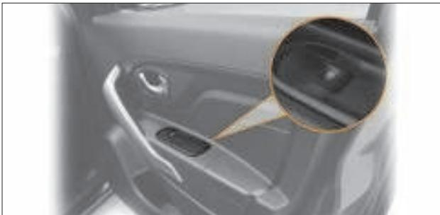
Рис. 1.19. Кнопка управления электрическим стеклоподъемником двери переднего пассажира
