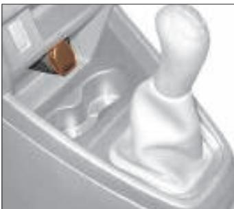
Рис. 7.3. Розетка для подключения дополнительного электрооборудования
