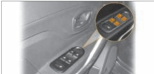
Рис. 1.17. Блок переключателей на двери водителя
