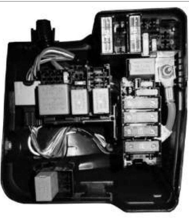
Рис. 8.28. Монтажный блок моторного отсека
