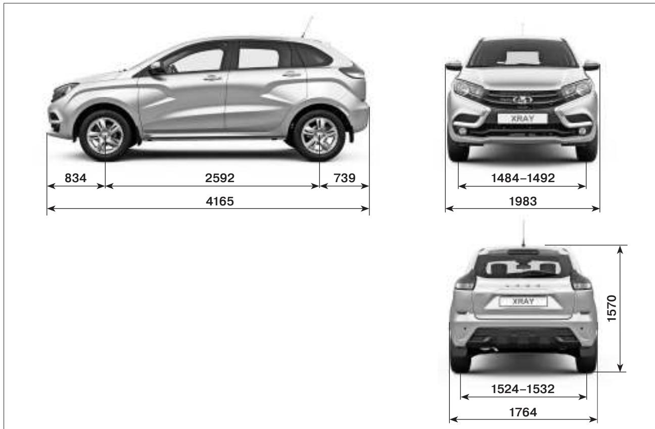
Рис. 10.3. Габаритные (справочные) размеры автомобиля XRAY
