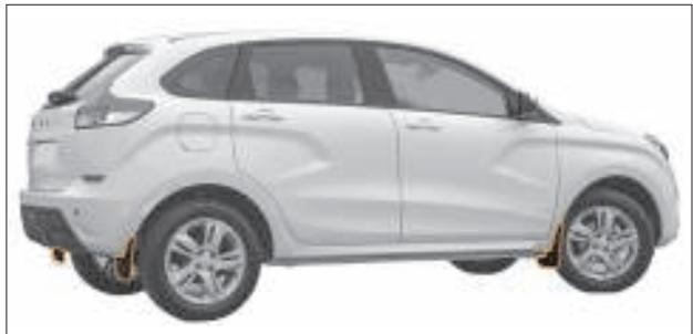
Рис. 9.10. Щитки переднего и заднего крыла
