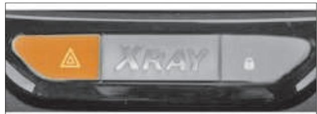
Рис. 1.11. Кнопка аварийной световой сигнализации
