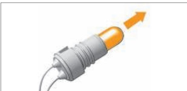
Рис. 8.21. Извлечение лампы
