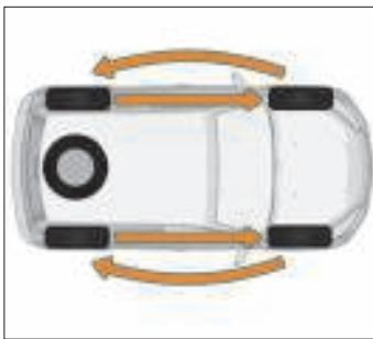
Рис. 9.3. Схема перестановки колес
