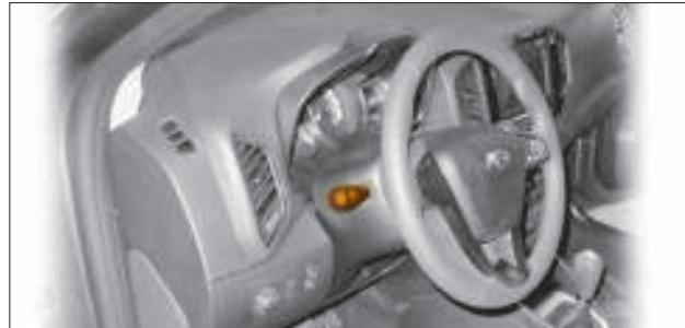
Рис. 1.22. Переключатель световой сигнализации
