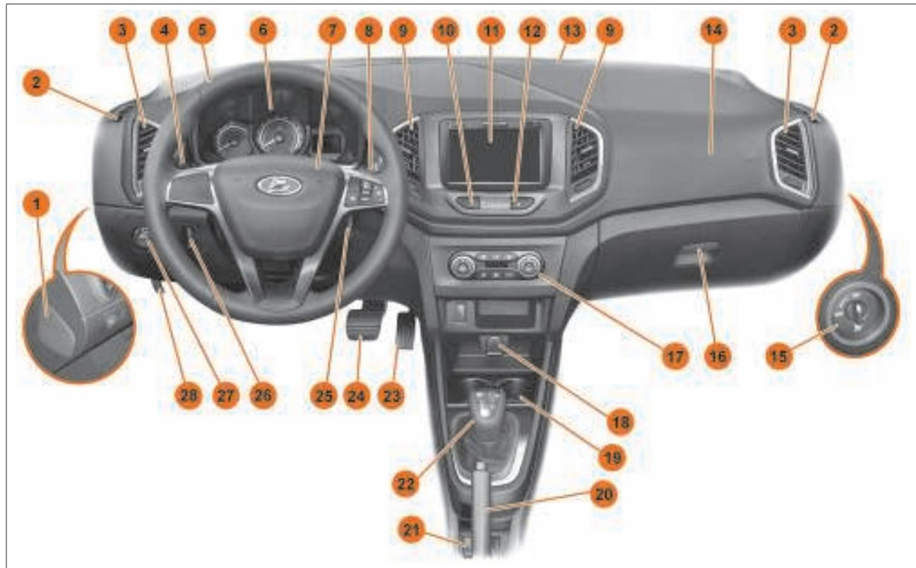
Рис. 3.1. Органы управления и приборы (в вариантом исполнении)
