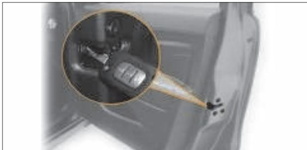
Рис. 1.14. Рычаг для запирания двери при деактивированных электрических приводах замков
