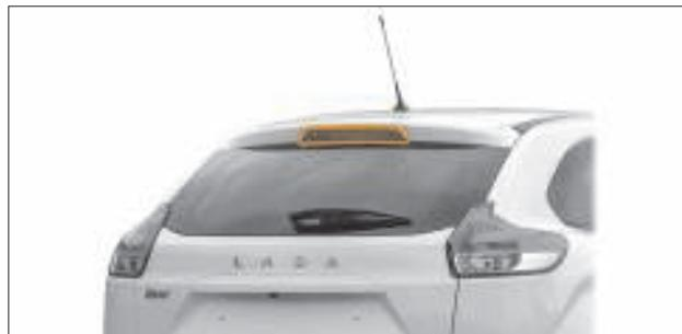
Рис. 8.23. Дополнительный сигнал торможения
