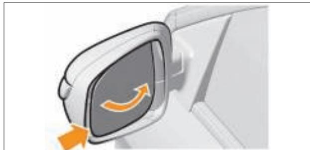
Рис. 8.15. Зеркальный элемент в максимальном боковом положении
