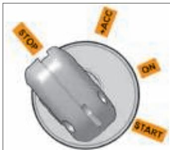
Рис. 1.7. Выключатель зажигания
