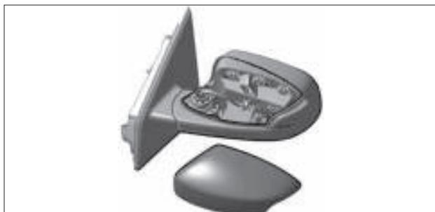
Рис. 8.19. Снятие накладки зеркала
