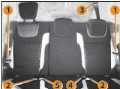
Рис. 2.9. Задние ремни безопасности
