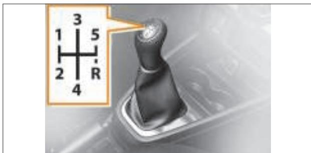
Рис. 4.1. Рычаг переключения механической коробки передач
