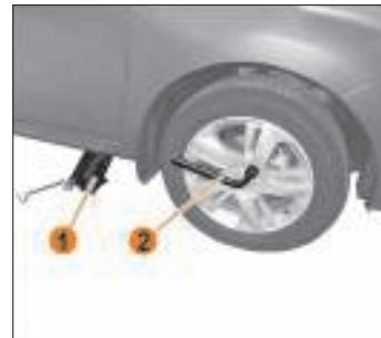
Рис. 9.5. Снятие колеса
