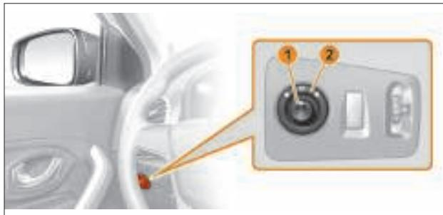
Рис. 3.13. Регулировка зеркал заднего вида с электроприводом
