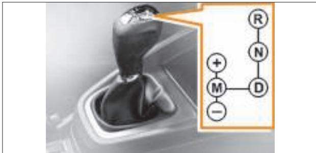
Рис. 4.2. Селектор автоматизированной трансмиссии
