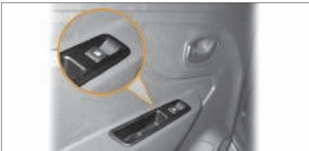
Рис. 1.20. Кнопка управления электрического стеклоподъемника задней двери (в вариантом исполнении)
