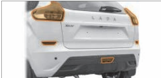
Рис. 9.12. Рассеиватели световых приборов задние
