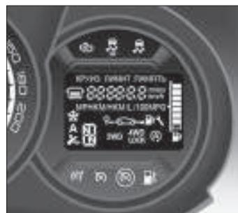
Рис. 3.7. Дисплей бортового компьютера
