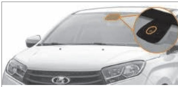
Рис. 1.26. Датчик дождя и света
