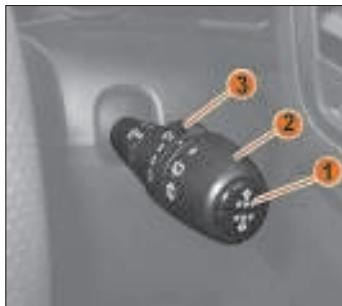
Рис. 1.27. Рычаг управления омывом и очисткой стекол
