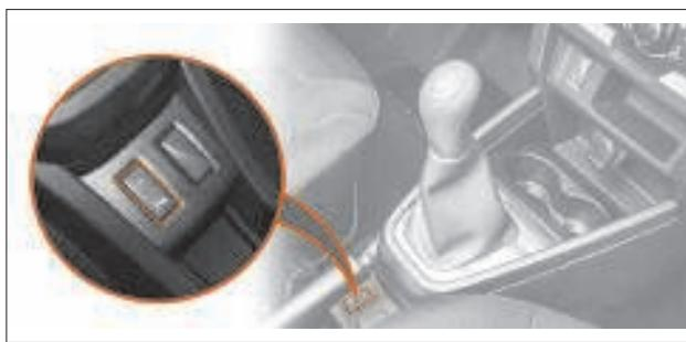
Рис. 5.3. Выключатель СБП
