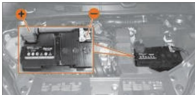
Рис. 8.9. Аккумуляторная батарея
