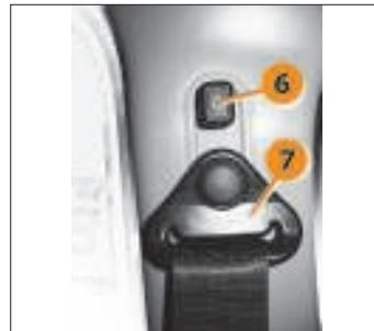
Рис. 2.10. Регулировка переднего ремня безопасности
