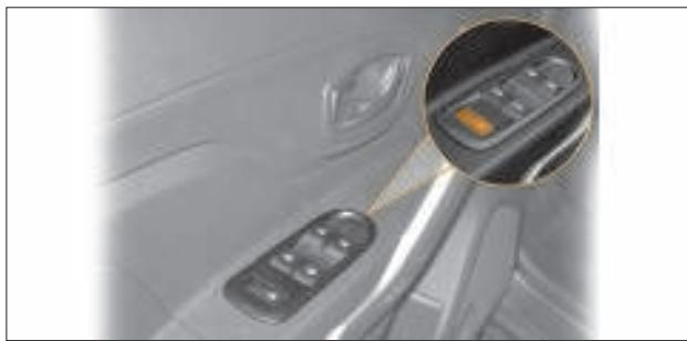
Рис. 1.18. Кнопка блокировки стеклоподъемников
