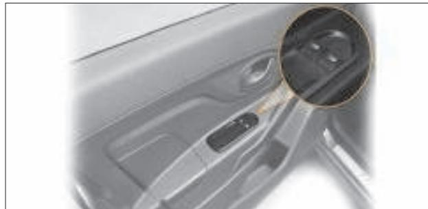
Рис. 1.16. Блок переключателей на двери водителя
