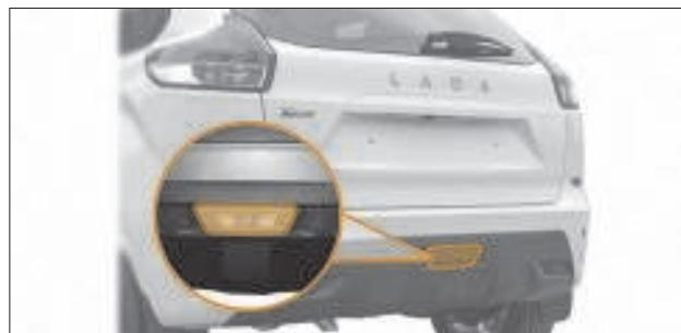
Рис. 8.14. Задний противотуманный фонарь
