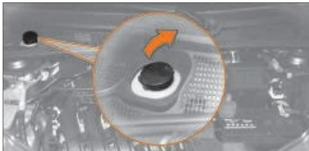
Рис. 8.8. Бачок стеклоомывателя
