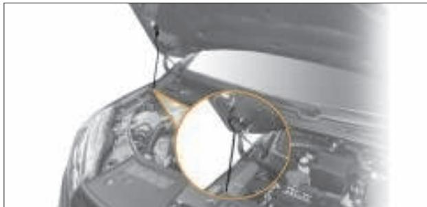
Рис. 8.3. Упор капота
