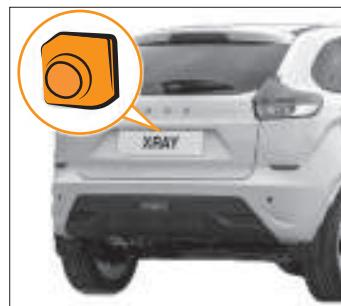
Рис. 5.4. Камера заднего вида
