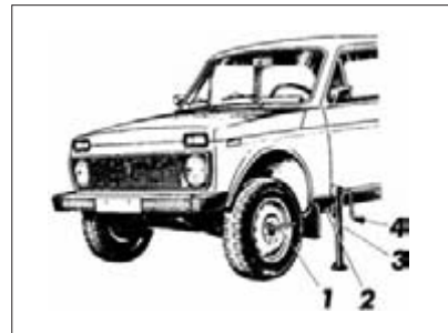
Рис. 35. Подъем автомобиля при замене колес
