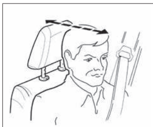
Рис. 11б. Оптимальное положение подголовника
