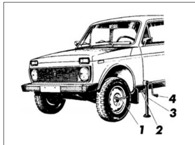
Рис. 44. Подъем автомобиля при замене колес
